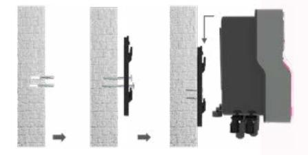
L'appareil BWT EasyDose se fixe facilement au mur grâce à la platine de fixation et les vis qui sont fournies avec l'appareil.
